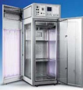
Camere climatiche con luci, con una capacità di 700 e 1.500 litri che consentono di abbinare cicli di illuminazione in condizioni di temperatura ed umidità prefissata. Consentono un'intensità luminosa di 20.000 lux.
