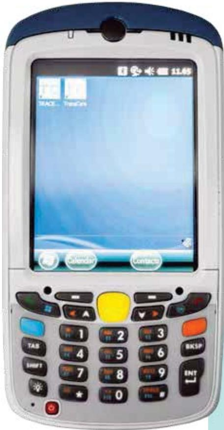
En cualquier UCE, la trazabilidad, ya sea manual o automática, es obligatoria para el personal del hospital. El nuevo sistema de trazabilidad desarrollado por CISA permite la monitorización del kit a través de todos los pasos en las zonas de la UCE. La estructura del producto es la de un sistema en red y los usuarios utilizan dispositivos móviles (PDAS).
